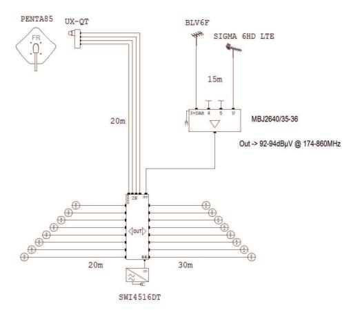
L'indicazione delle antenne nello schema è puramente indicativa in quanto la scelta dipende esclusivamente dalla tipologia di segnale TV ricevuto nella zona di realizzazione dell'impianto.
